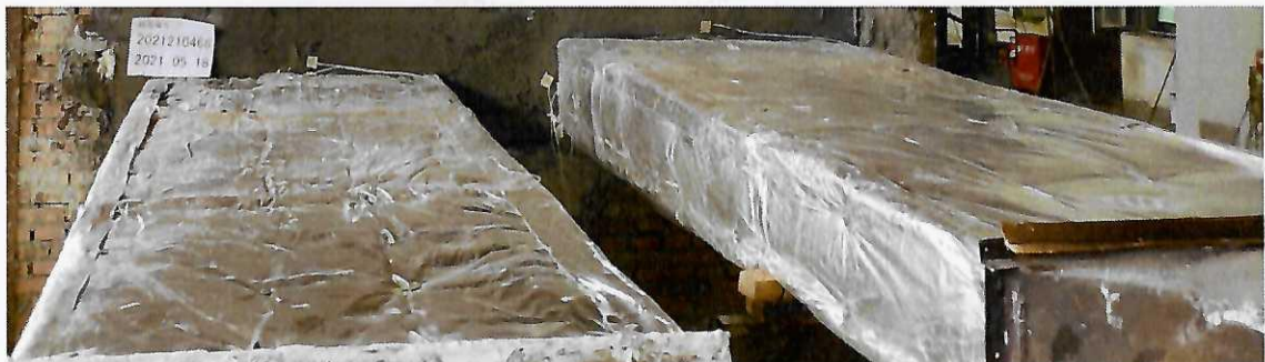
照片 2 耐火试验结束时试件情况
