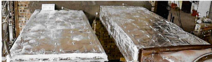
照片 2 耐火试验结束时试件情况
