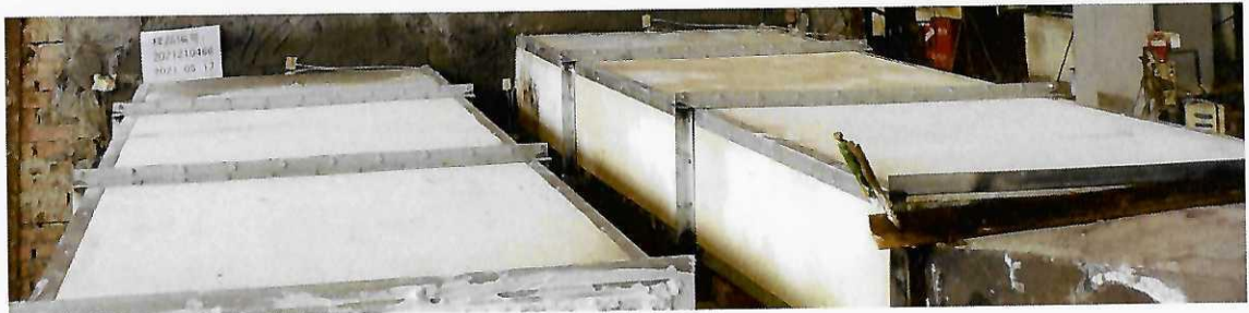
照片 2 耐火试验结束时试件情况
